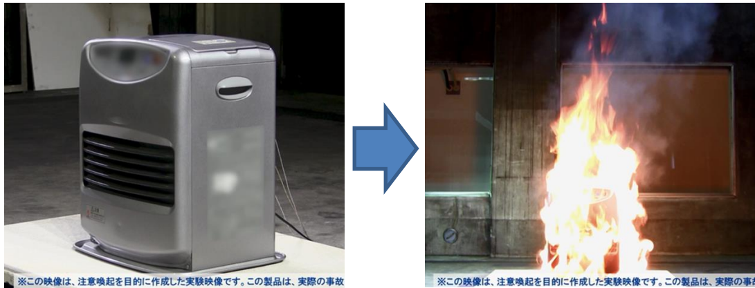
写真1. 石油ファンヒーターにガソリンを誤給油して発火
